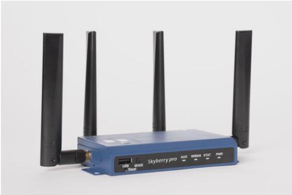
MVNOとしての特性を生かし、通信事業大手3社の無線回線に加え、光回線、衛星回線も含めた5回線を活用できるネットワークの冗長化ソリューションです。通常使っている光回線や衛星回線を「スカイベリーpro®」につなげておくことで、災害による断線等や気象の変化で通常回線が使えなくなった時も、自動的に無線回線への切り替えが行われます。無線回線ではドコモ/au/ソフトバンクの独立した3回線を使え、通信がつながっているものを優先順位順に使用することができます。
