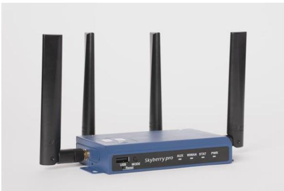
MVNOとしての特性を生かし、通信事業大手3社の無線回線に加え、光回線、衛星回線も含めた5回線を活用できるネットワークの冗長化ソリューションです。通常使っている光回線を「スカイベリーpro®」につなげておくことで、災害による断線等で光回線が使えなくなった時も、自動的に無線回線への切り替えが行われます。無線回線ではドコモ/au/ソフトバンクの独立した3回線を使えるため、有線回線が断絶した際にも、無線の3回線のうち通信がつながっているものを優先順位順に応じて
